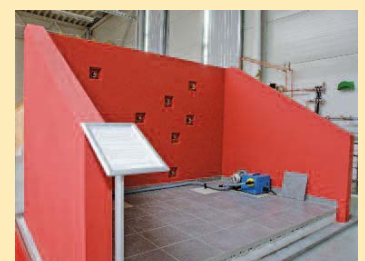
Der neue MBS Wasserschadensimulator für das praxisnahe Training unterschiedlicher Schadenortungsverfahren.
