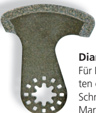
Diamantschneideblatt rund Ideal für Fliesenfugen. Schnittbreite ca. 2,2 mm für alle Marmor-, Epoxydharz- und Zementtrassfugen. Passend für Fremdfabrikate mit Sechskant Werkzeugaufnahme.
